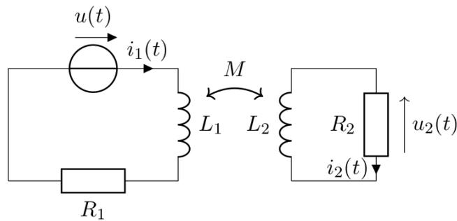
Soit  $\Phi_1$  le flux magnétique à travers le premier circuit. Ce flux est la somme du flux propre  $\Phi_{p,1}$  et du flux  $\Phi_{2 \rightarrow 1}$  créé par le 2eme circuit. Ainsi :
