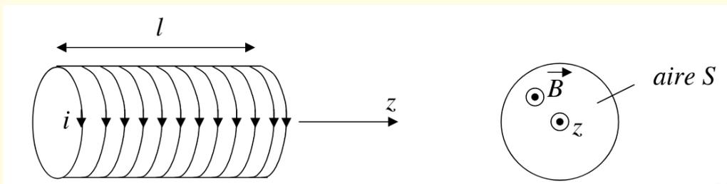
Déterminer l'inductance propre de la bobine. Estimer l'ordre de grandeur de l'inductance d'une bobine de 1000 spires de rayon 3cm et d'une longueur 30cm.
