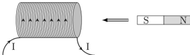
Si on approche une face sud, c'est à dire un champ magnétique dirigé vers la droite, un courant induit apparaît, son sens crée un champ magnétique dirigé vers la gauche.
