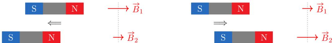
Observons le sens du champ magnétique induit à cause de l'apparition du courant dans la spire.
