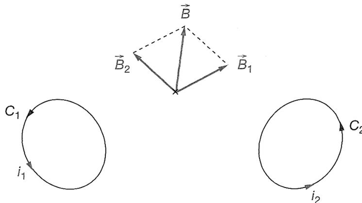
Considérons deux circuits fixes indépendants. Le circuit 1 est parcouru par un courant  $i_1$  qui génère un champ magnétique  $\vec{B}_1$  et le circuit 2 est parcouru par un courant  $i_2$  qui génère un champ magnétique  $\vec{B}_2$ . Le champ magnétique total est donc  $\vec{B} = \vec{B}_1 + \vec{B}_2$ .
