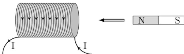
Si on approche une face nord d'un aimant droit au voisinage de la bobine, c'est à dire un champ magnétique dirigé vers la gauche, alors un courant induit apparaît dans celle-ci dans un sens qui lui fait créer un champ magnétique vers la droite (on peut raisonner en terme de faces magnétiques : on approche une face nord, le circuit oppose alors une face nord).
