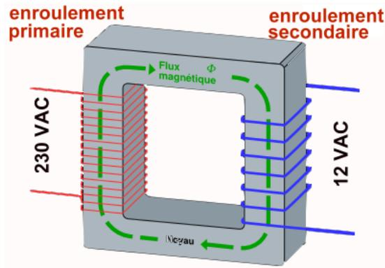
Pour utiliser un transformateur, on met une source de tension variable au niveau du primaire. L'intensité  $i_1$  parcourant les boucles de courant crée un champ magnétique variable. Ce champ magnétique induit un courant au niveau du secondaire. Dans un schéma électrique un transformateur peut-être représenté par un de deux symboles suivants :
