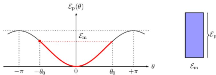
(d) La masse a perdu toute son énergie cinétique et a maximisé son énergie potentielle. Elle a atteint l'angle maximal  $-\theta_0$ . Ensuite, la masse repart dans l'autre direction et oscille.
