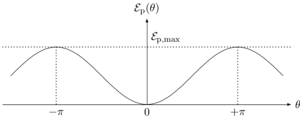
On remarque que l'énergie potentielle admet un maximum  $E_{p,\max} = 2mhl$  pour les angles  $\theta_{\max} = \pi[2\pi]$  alors que l'énergie est minimale pour  $E_{p,\min} = 0$  pour  $\theta_{\min} = 0[2\pi]$ .
