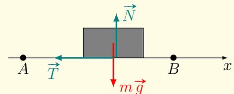
Montrer que la force de réaction normale ne travaille pas et que le travaille de la force de réaction tangentielle entre un point  $A$  et un point  $B$  vaut :
