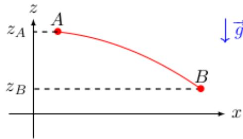
En coordonnées cartésiennes, on a  $\vec{dl} = dx\vec{e}_x + dy\vec{e}_y + dz\vec{e}_z$ . Ainsi  $\delta W = m\vec{g} \cdot \vec{dl} = -mgdz$  soit :
