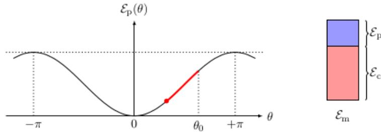
(b) La masse perd de l'énergie potentielle en restant sur la courbe. L'énergie mécanique étant conservée, elle gagne de l'énergie cinétique et donc de la vitesse.
