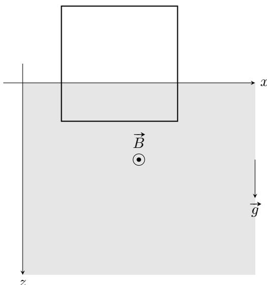
Soit un cadre carré conducteur (de côté  $a$ , masse  $m$ , résistance  $R$ , inductance propre  $L$ ) situé dans le plan  $xOz$ . A  $t = 0$ , le côté inférieur du cadre se trouve en  $z = 0$  au bord d'une zone où existe un champ magnétique  $\vec{B} = B\vec{u}_y$ . Ce champ existe uniquement dans la zone  $z > 0$ . A l'instant initial, la vitesse du cadre est  $v_0\vec{u}_z$  dirigée vers le bas.
