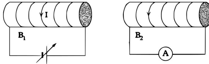
1. Le courant  $I$  dans  $B_1$  étant constant, un courant circule dans  $B_2$  dans le sens indiqué sur la figure.
